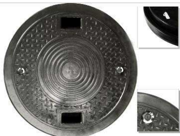
Pokrywa Z-600/DN624-PE przenosząca obciążenia 15 kN z zamkami i uszczelką gumową DN624
